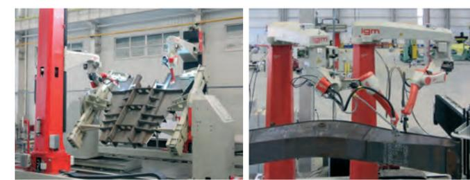
Columna de elevación RSH con corredera transversal TQA, rango de recorrido: de 1.5m a 3 m
